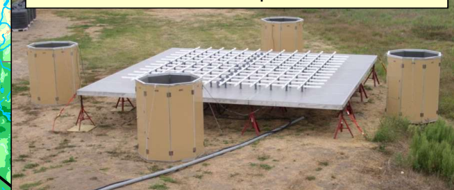
1/4-scale 449-MHz wind profiler with RASS
